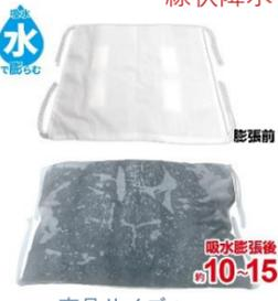
土や砂を使わずに水だけで膨らむ！1袋につき約10Lの水に浸してもみほぐします。約10分程度で吸水し、約10～15Kgの土のう袋になる。四隅に紐が付いているので、何かに固定したり、土のう袋同士と結んで流れにくくすることもできる。使用後は中央あたりをカッターで切って3～4日天日干した後、一般ごみとして処理できる。
